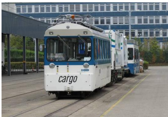
Die Cargo-Tram wurde kostengünstig aus vorhandenem Rollmaterial hergerichtet
